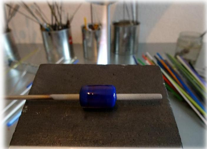
2. Mit der Parallelzange flachquetschen, darauf achten das das Ganze nicht zu dünn gepresst wird- wenn man exakt gearbeitet hat, sieht das Rechteck jetzt schon ganz gut aus.
