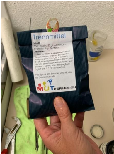
Abbildung 4: Trennmittel Quelle: eigenes Foto
